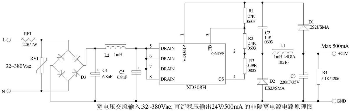
**【附注】** XD308H 是一款 18-600Vdc 超宽范围输入的高压降型 AC-DC 转换器电源芯片，可适应 12-380VAC 超宽电压输入(外部加整流滤波)，最大输出持续电流可以达到 500mA（峰值 800mA），无音频噪音、发热低，内部集成全面完善的保护功能（短路保护，过载保护，输出过压保护、输出欠压保护，过热保护等）。该电源芯片以较低的成本（外围元件数目极少）方便的实现宽电压高压降压小功率电源解决方案，广泛应用于非隔离型家电产品(220ac)和工业产品(380Vac)等。
